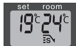
J: Se la spia luminosa SAVE si accende, la stufa si accende e si spegne automaticamente, per rimanere entro una determinata temperatura.
