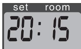
F: Nel momento in cui i quattro numeri smettono di lampeggiare, la stufa è stata programmata secondo i dati impostati.
