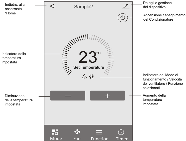
Display del controllo principale
